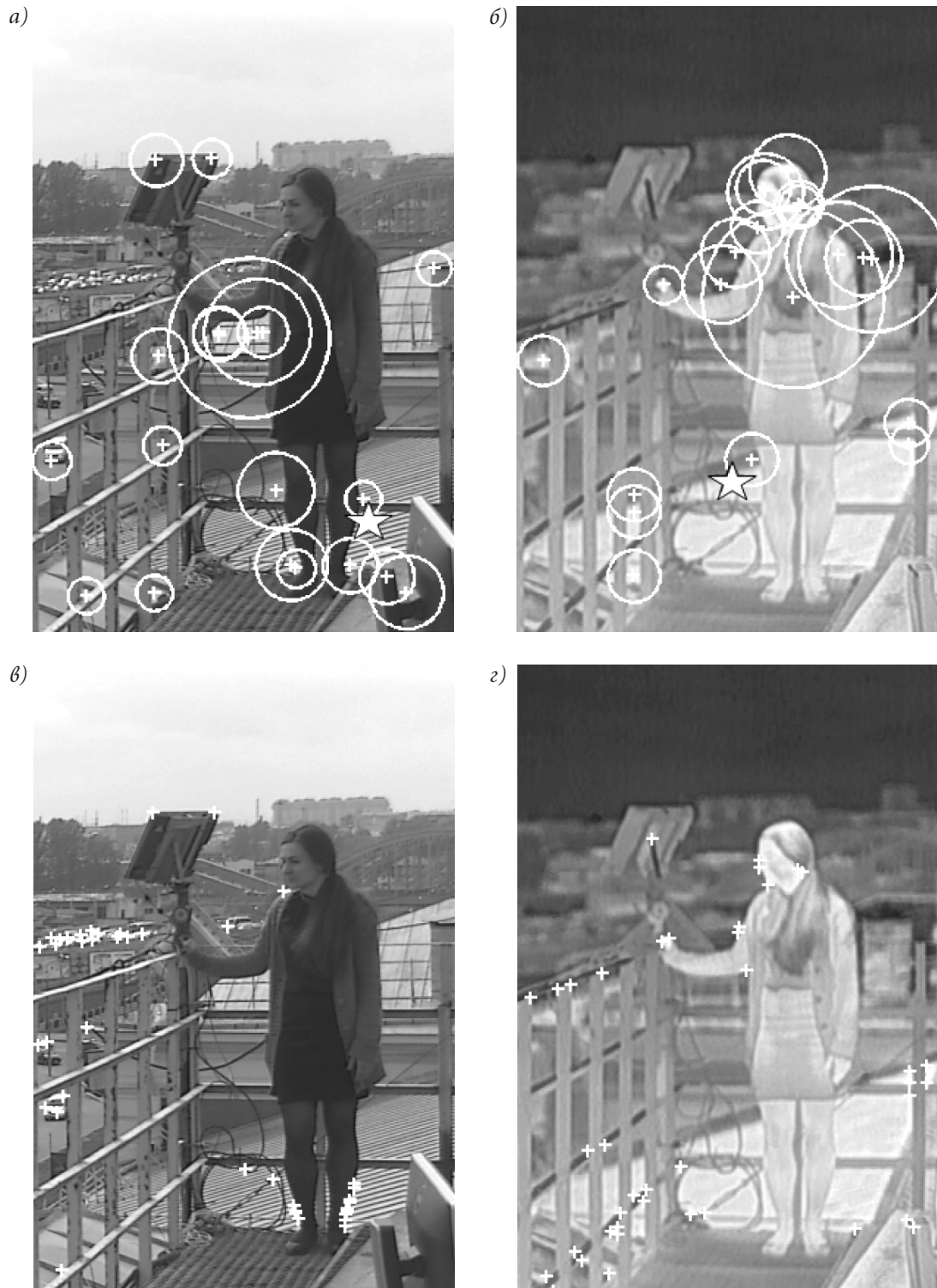
Рис. 2 Пример № 2. Нахождение особых точек: а — метод SURF, изображение от видеокамеры; б — метод SURF, изображение от тепловизора; в — метод Харриса, изображение от видеокамеры; г — метод Харриса, изображение от тепловизора
