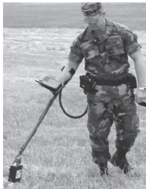
Рис. 2 Детектор на основе токопроводящих полимеров для обнаружения МВУ в земле
